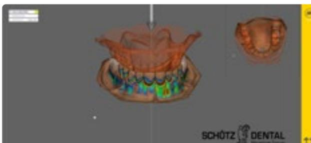
Hochpräzise Darstellung der Unterschnitte anhand der Einschubrichtung.
