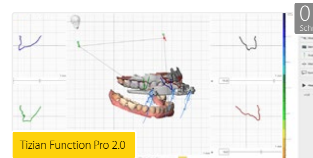
Aufzeichnung der UK-Bewegung inkl. des digitalen Gesichtsbogens in der Tizian Function Pro 2.0 Software.
