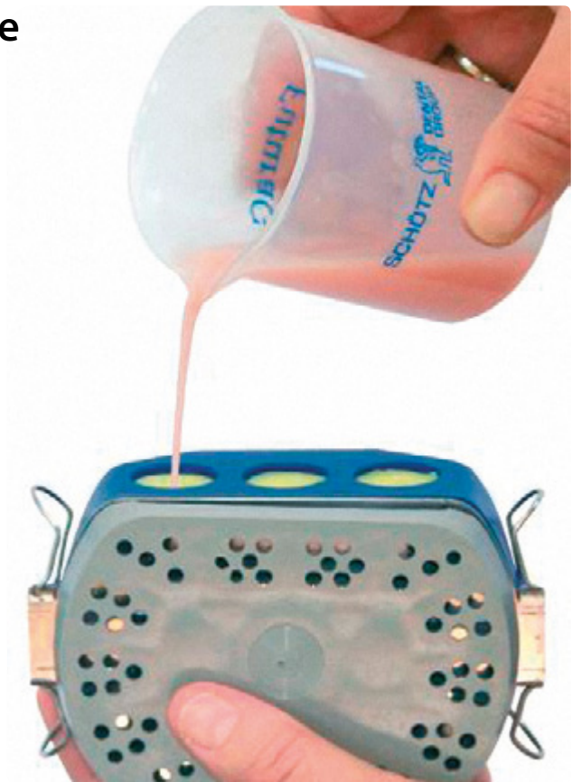
FuturaJet in the pouring technique
